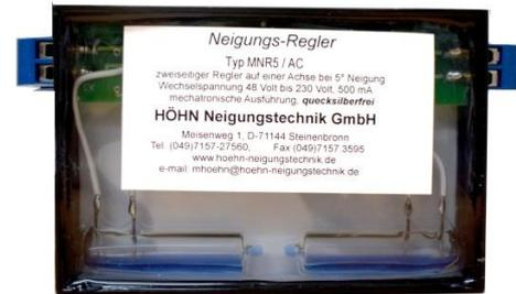
**Beschreibung:** In ein Gehäuse sind zwei Leistungselektroniken, verbunden mit zwei Flüssigsensoren eingebaut. Diese haben Messleitungen, welche separat mit je einer Elektronik verbunden sind. Neigungsänderungen werden damit erfasst, und an die zuständige Elektronik weitergeleitet. Die gemessenen Änderungen werden als Impuls von den Elektroniken erfasst, und in eine Schaltung verwandelt.
